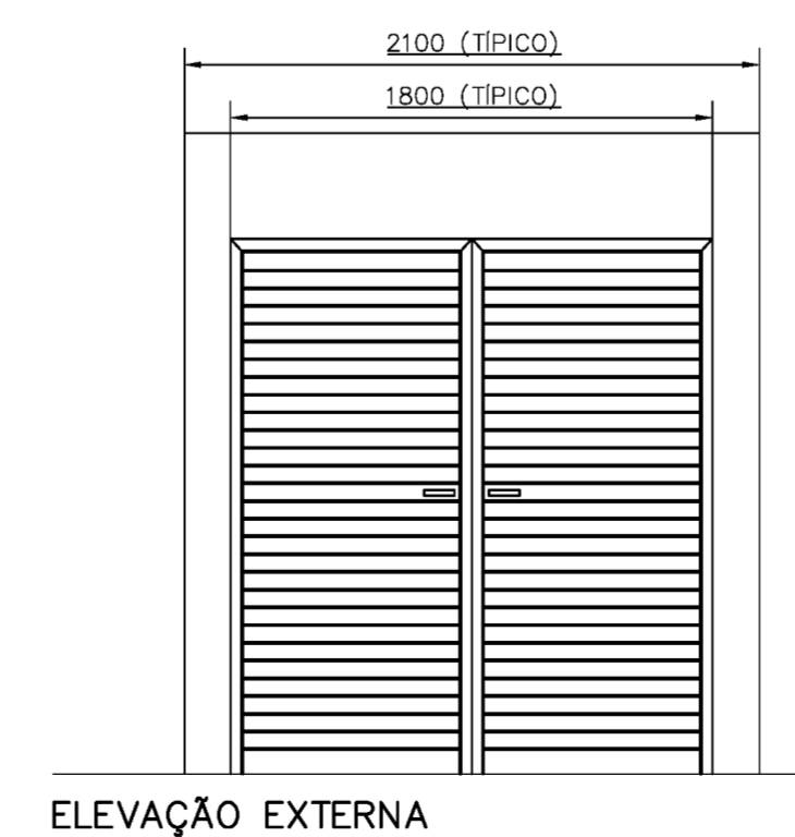
DETALHE SUGESTIVO DE PROTEÇÃO EM ALVENARIA PARA PAINÉIS S/ ESC.
